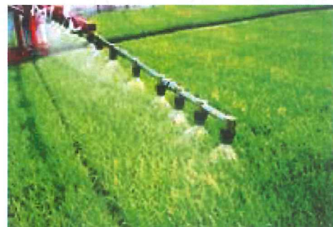
ブームの両端のノズルを増設。大型ハウス でもすみずみまで水が行き渡ります。
